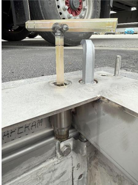
6. Nivellierung mit der Kontermutter arretieren (Innensechskant 14 mm)
