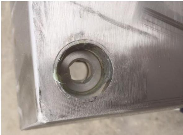
Die Kontermutter wird zuerst gut eingefettet und dann vorsichtig mit dem 12 er Inbus von unten eingedreht – Vorsicht wegen Verkannten, das Gewinde muss gut laufen, falls es etwas hakt sofort zurück, reinigen, neu fetten, neu Ausrichten und nochmals versuchen bis die Kontermutter sauber bis ganz nach oben zum Anschlag geschraubt wird.
