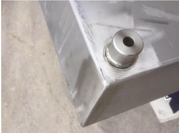
Dasselbe gilt dann auch für die Regulierungsschraube welche zuerst gut gefettet und dann vorsichtig von Hand von unten mit dem Gewinde voran eingesetzt und etwas angedreht wird. Diese wird dann von oben bis zum Anschlag mit dem 14 er Inbus bis zum Anschlag eingedreht.
