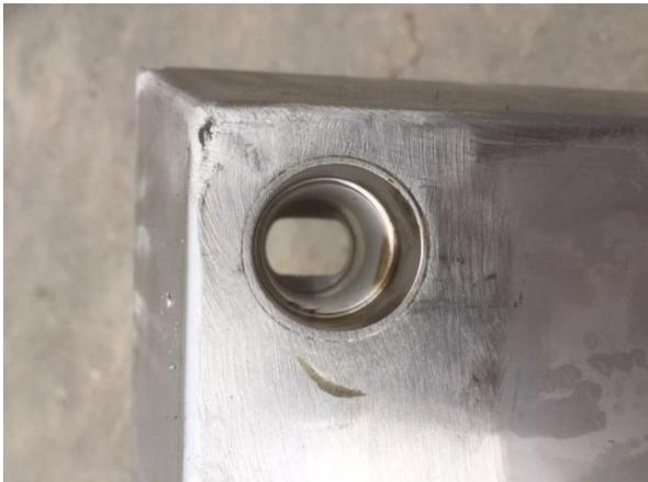
Als erstes muss der Deckel umgekehrt und gesichert werden. Dann wird das Schlüsselstück und das innenliegende Feingewinde von unten gut gereingt. Es darf kein Schmutz mehr auf dem Feingewinde sein, da ansonsten die Gefahr vom Ein - Fressen des Gewindes besteht.
