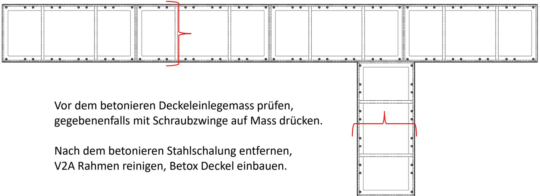
Vor dem betonieren Deckeleinlegemass prüfen,
