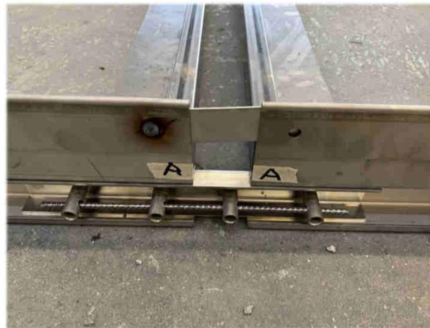
4. Rahmen verschrauben, Konsole Montieren und M20 Schraube setzen.
