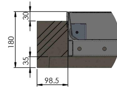
Bis 3cm Betoniert ohne Schacht
