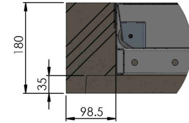
Bis 3cm Betoniert für modularer Schacht
