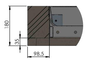
Bis 3cm Betoniert für modularer Schacht Deckel Schwarz
