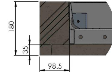
Bis 3cm Betoniert für modularer Schacht
