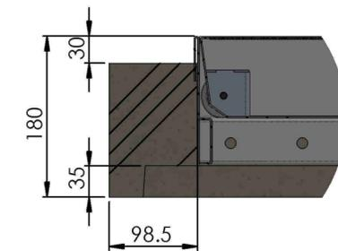
Bis 3cm Betoniert ohne Schacht
