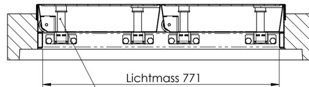
4x M20x100 Innensechskantschraube pro Decke (ausser bei B125)
