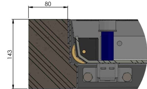
Bis 3cm Betoniert ohne Schacht
